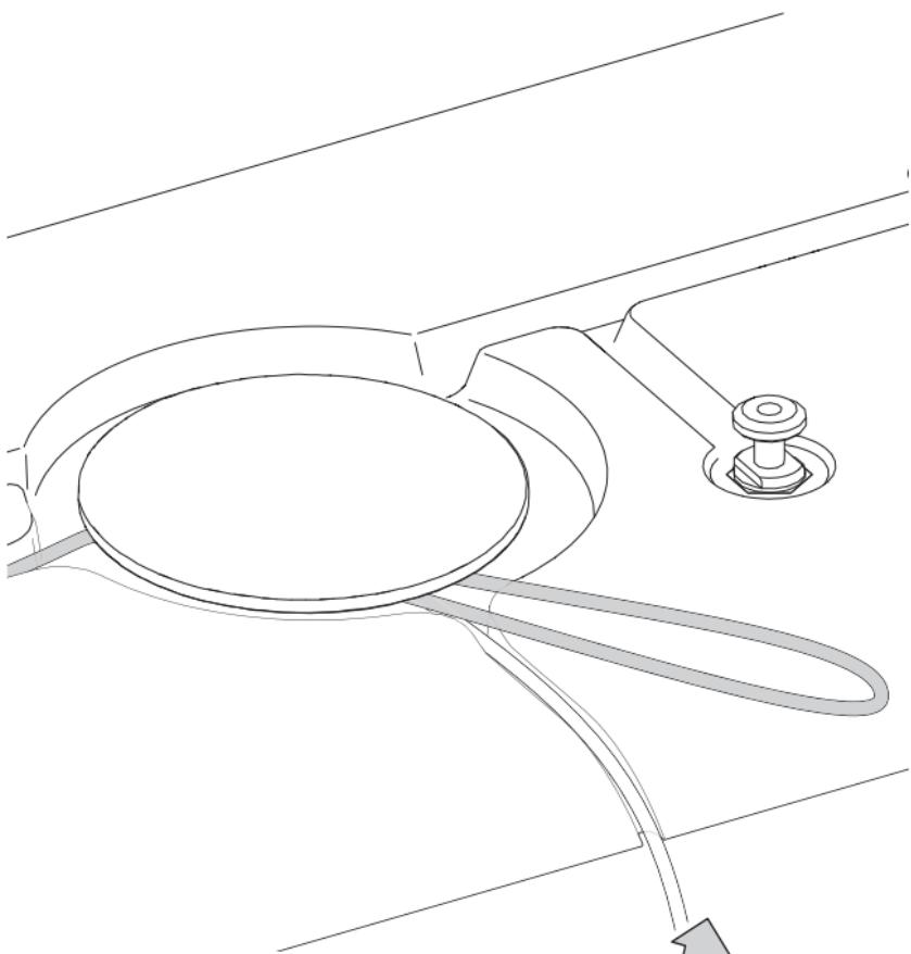
Kabel, wie abgebildet, doppelt aufwickeln (die Kabelaufwicklung kann max. 1,5 m Kabel aufnehmen).
