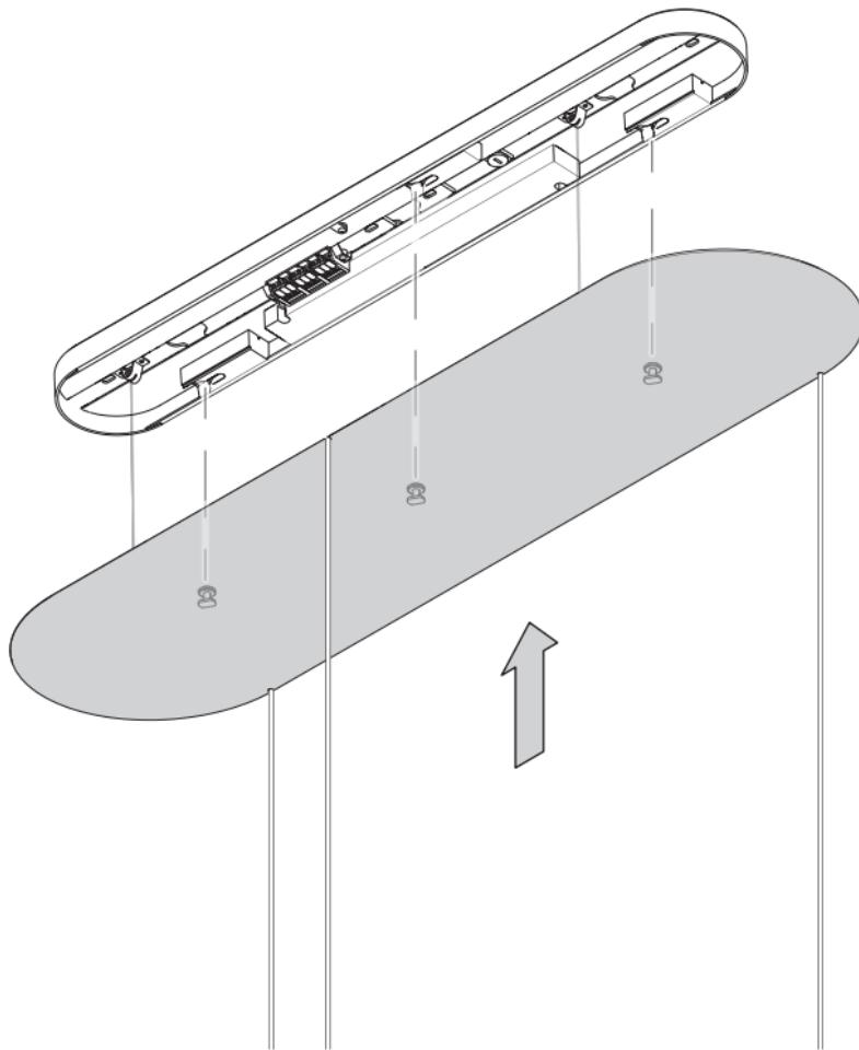
Baldachin einsetzen, bis dieser hörbar einrastet!
