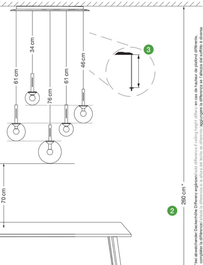
\* bei abweichender Deckenhöhe Differenz ergänzen / add difference if ceiling height differs / en cas de hauteur de plafond différent, compléter la différence / añada la diferencia si la altura del techo es diferente / aggiungere la differenza se l'altezza del soffitto è diversa
