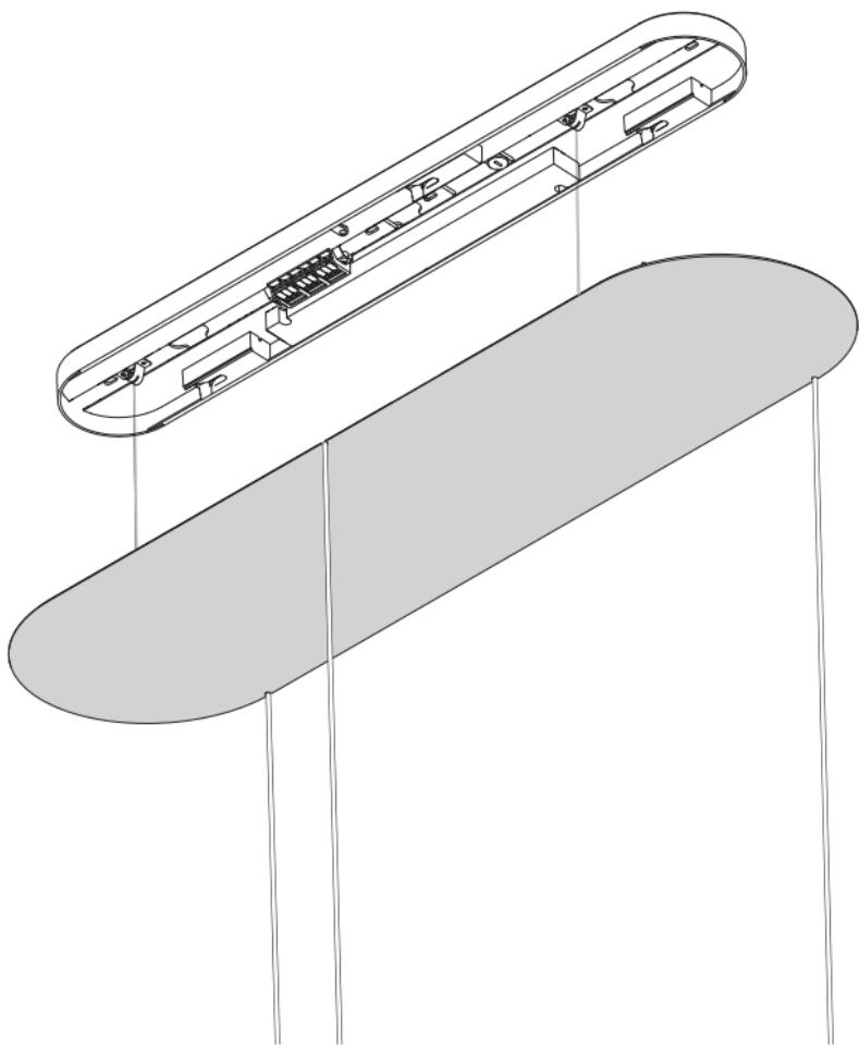
Baldachin eben auf die Montageplatte setzen
