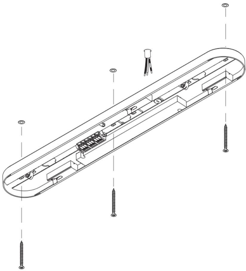
Kabel zugentlasten und wie abgebildet verkabeln
