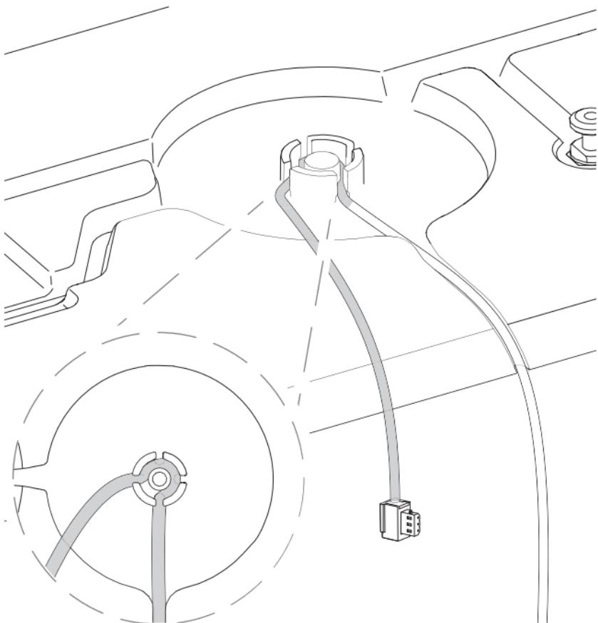
Kabel wie abgebildet zugentlasten
