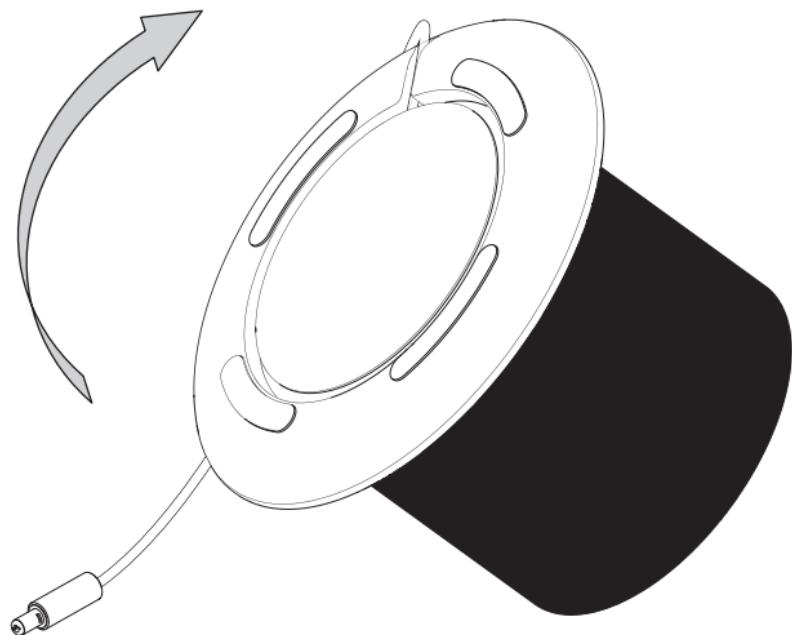
Kabel, bis die gewünschte Länge erreicht ist, aufwickeln. Kabel zugentlasten.
